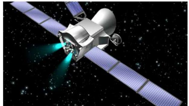
FIGURE 1- Illustration d'artiste de la sonde **BepiColombo**, propulsé par deux moteurs ioniques.
